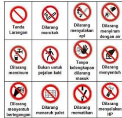
Papan tanda keselamatan kebakaran hendaklah mematuhi MS 982:1985
